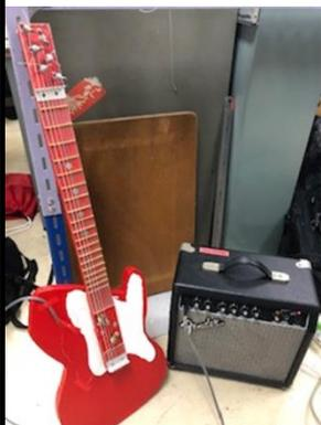
この教材は木材、アクリル板、アルミ板、磁石、ネジなど比較的身近なものでエレキギターを作製した。この教材のねらいはエレキギターに電磁誘導が利用されている事に着目し、その仕組みを通して電磁誘導についての理解を促すことである。
