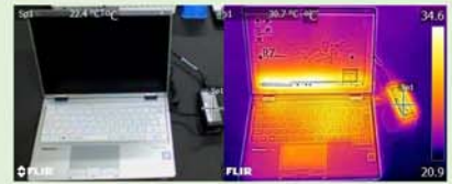
↑ACアダプターの発熱を可視化（サーモ画像）
